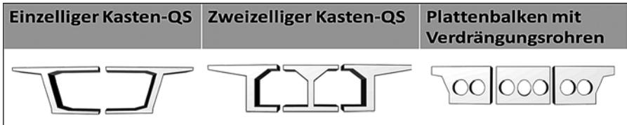
Bild 4: Komplexe Querschnittsmodelle zur Erfassung der Profilverformung
