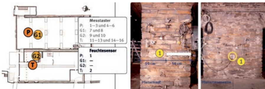
Bild 17: Ausgesuchte Stellen im Weinkeller zur Feuchtegehaltsmessung am Grauwacke-Bruchsteinmauerwerk; links: Grundriss, P: Pfeiler; G: Gewölbe; T: Trennwand (a); rechts: Feuchtegehaltsmessung an Längsseite eines Mauerwerkpfeilers (P) mit dem Feuchtemesssensor 1 [11] Grundriss: [4], Fotos: [10]
