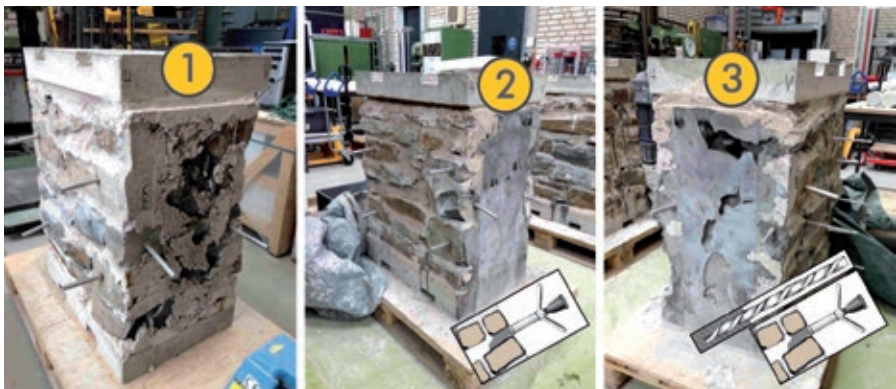
Bild 10: Mauerwerkprüfwände (Zweischalenkonstruktion mit mittiger Verfüllung); (1): aus May-schoß-Grauwacke aufgemauert; (2): zusätzlich injiziert, (3): injiziert und vernadelt
