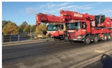
Bild 11: Belastungsversuch Kranüberfahrt (60 t + 40 t) Foto: Dirk Sperling
