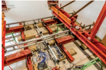
Bild 5: Belastungsversuch an den Kappendecken über UG Foto: Gerd Kapphahn
