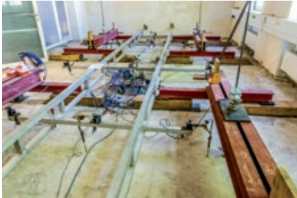
Bild 12: Versuchsaufbau mit Lasteinleitung und Messbezugsbasis
