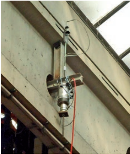
Bild 5: Versuchsaufbau zur Belastung der Halfenschienen Foto: HOCHTIEF
