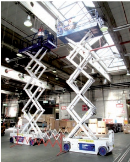
Bild 6: Durchführung der Belastungsversuche von zwei Scherenhubbühnen aus Foto: HOCHTIEF
