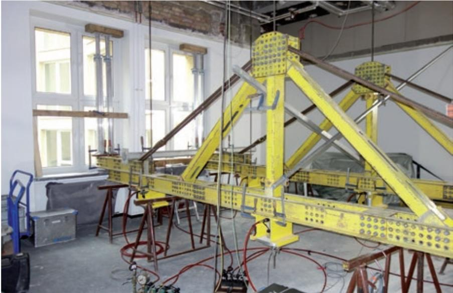
Bild 5: Belastungsrahmen mit Hydraulikpresse und Zugstangen
