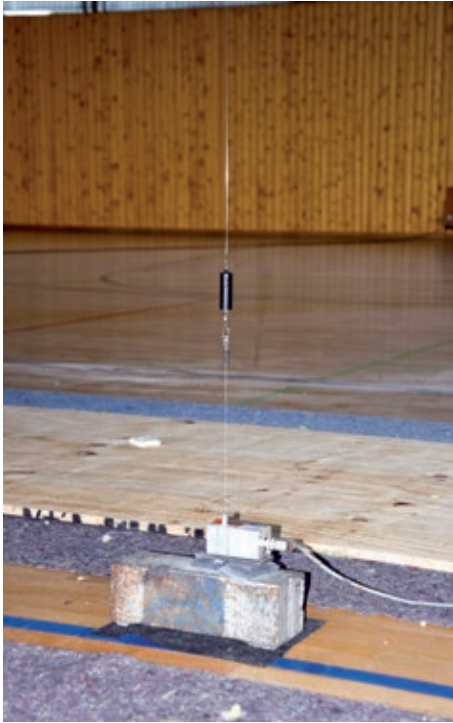
Bild 12: Messung der Faltendurchbiegungen mit Seilwegaufnehmern Foto: Robert Herold
