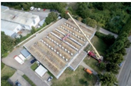
Bild 9: Belastungsanordnung auf dem Sporthallendach aus der Vogelperspektive Foto: David Rieger
