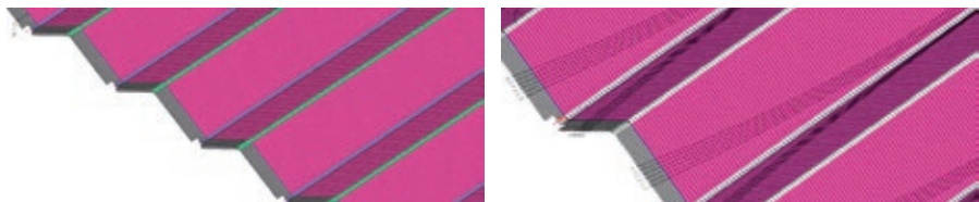
Bild 6: Ausschnitt aus dem FE-Modell der Dachkonstruktion mit Fertigteilen, Randverstärkungen und Fugen in den Faltentälern und -dächern sowie mit den verlegten Spanngliedern Grafik: Elke Reuschel
