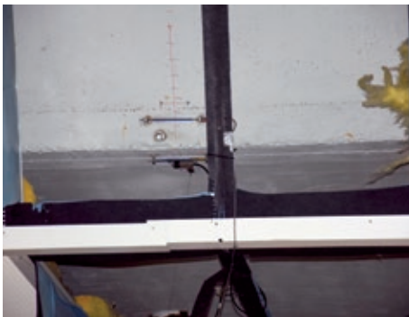
Bild 13: Messung der Betondehnungen in den Faltentälern mit induktiven Wegaufnehmern Foto: René Fritzsche
