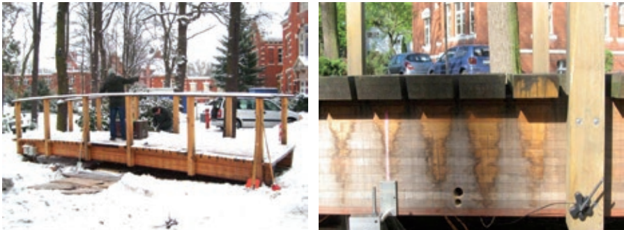
Bild 3: Brettschichtholzträger auf dem Testgelände der BAM mit Schädigung durch zwei Bohrlöcher. Die Brücke besitzt an der Ober- und Unterseite jeweils eine Lamelle aus Kunstharzpressholz (KHP), deren Elastizitätsmodul um den Faktor 7 größer ist als derjenige der mittleren Lamellen. Fotos: Klaus Brandes
