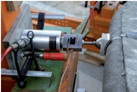
Bild 6: Belastungseinrichtung mit Hydraulikzylinder und Passstück am Handlauf der Balustrade Foto: Sabine Wellner
