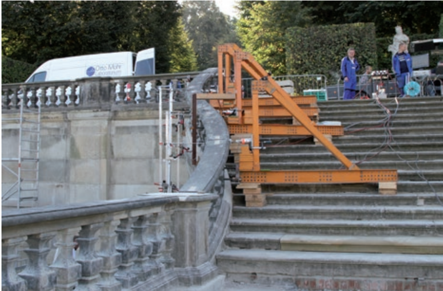
Bild 5: Belastungsversuch an einer Balustrade der „Stillen Musik“ Foto: Sabine Wellner
