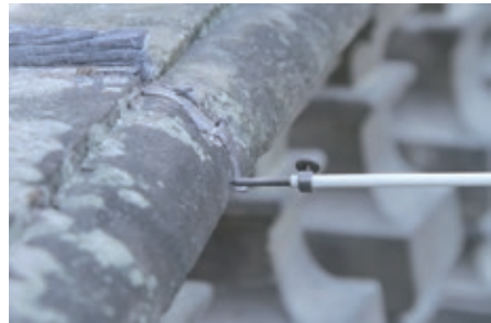
Bild 7: Wegaufnehmer zur Erfassung von Verformungen des Handlaufs Foto: Sabine Wellner
