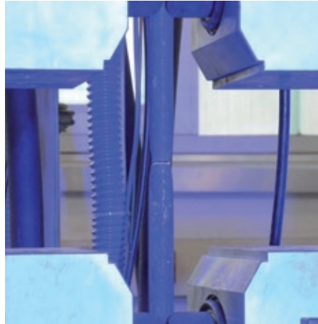
Bild 11: Bestimmung der Zugfestigkeit des entnommenen historischen Bewehrungsstahls; in der Mitte ist deutlich die Einschnürung im Bruchbereich zu erkennen
