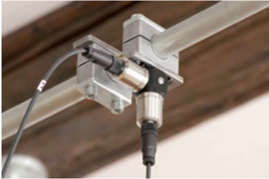
Bild 2: Beschleunigungssensoren an einem Horizontalstab bei der Frequenzbestimmung im Sommer 2015 Foto: Sabine Wellner
