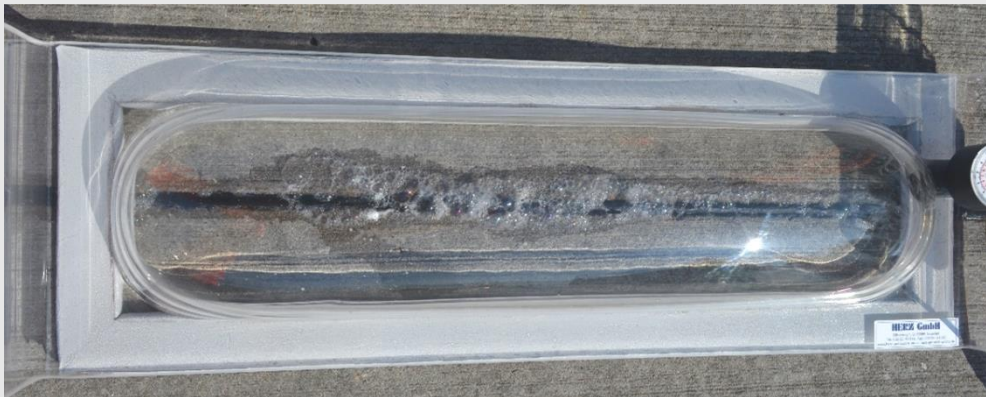
Dichtheitsprüfung mit Saugglocke
