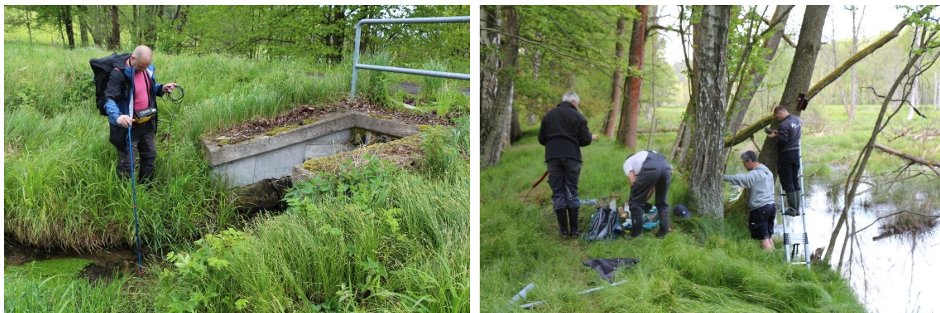
Abb. 4–5: Fließgeschwindigkeitsmessung (links) und Installation temporärer Messpegel (rechts) am Liščí potok (Fotos: S. Thepphachanh).
