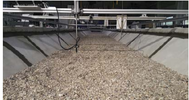
Abb. 2: Modellversuch zur Untersuchung der Gewässersohlenstruktur an der TU Dresden (Foto: S.-Chr. Mietz)
