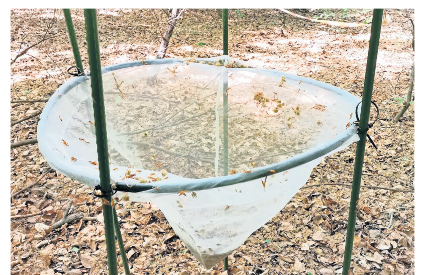
Mit Fangkörben werden die von den Kronen abfallenden Blätter, Blütenteile und Äste aufgefangen.
