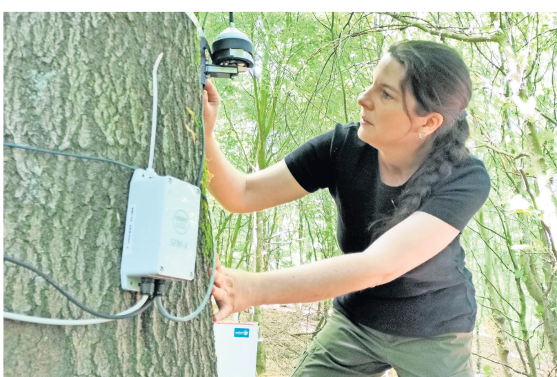
Britt Kniesel beim Justieren eines Dendrometers, welches das Dickenwachstum des Baumes aufzeichnen kann.
