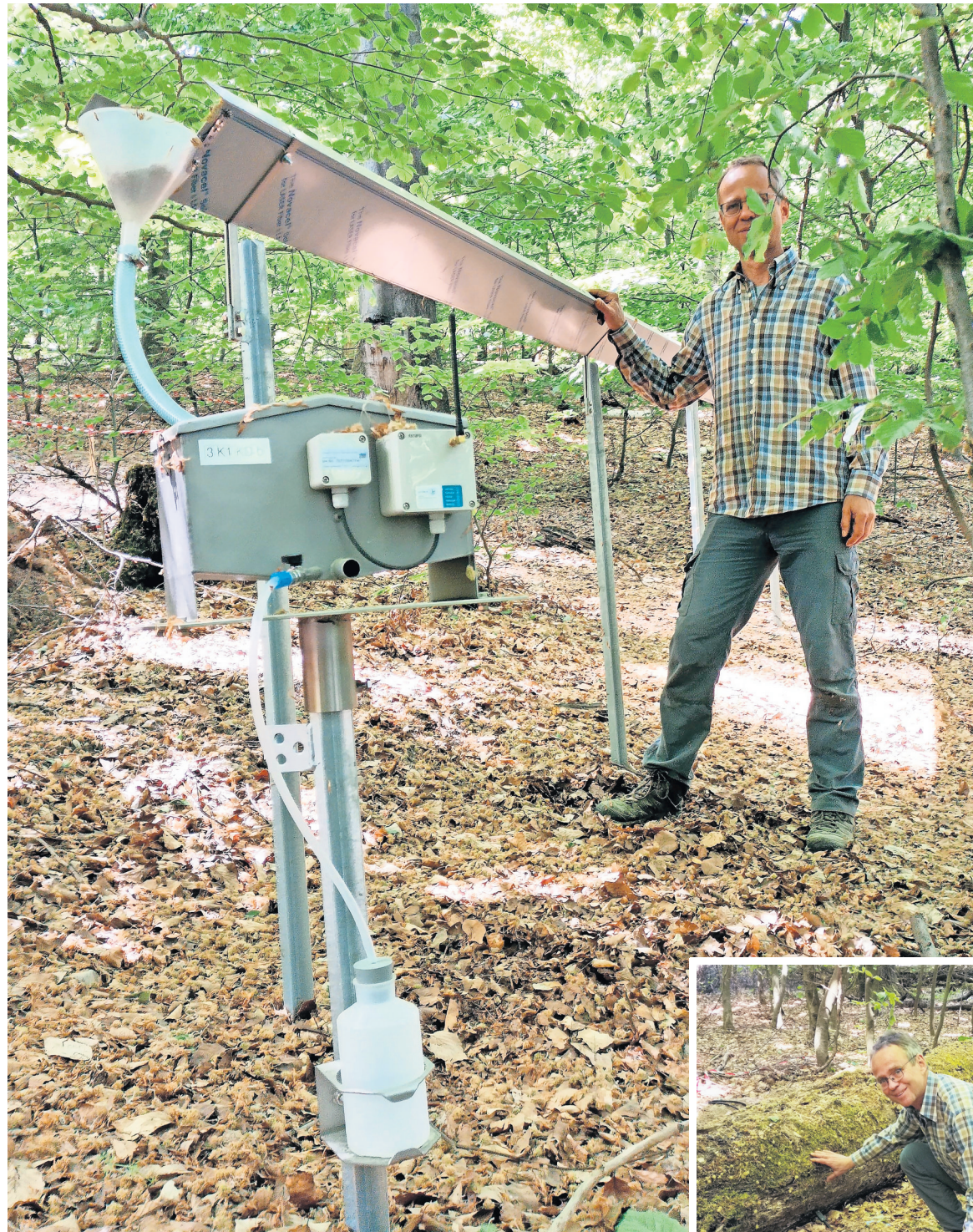
Karsten Kalbitz in seinem „Labor“ mitten im Wald: Mit dieser Art Rinne wird unter dem Kronendach Niederschlag aufgefangen und gemessen. Das Foto rechts zeigt den Professor an einem sensorbestückten Totholzstamm.
