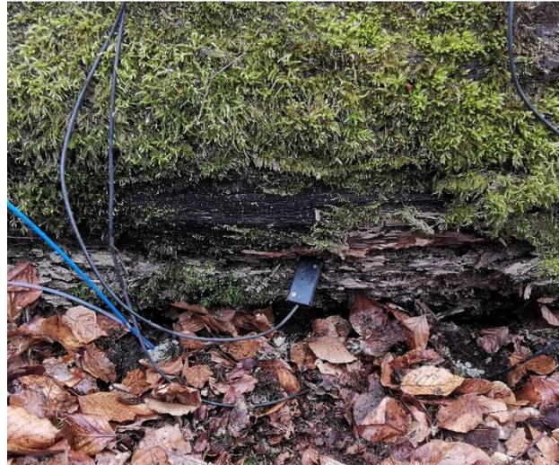
**Abb. 4** SMT Sensor in stark zersetztem Totholz
