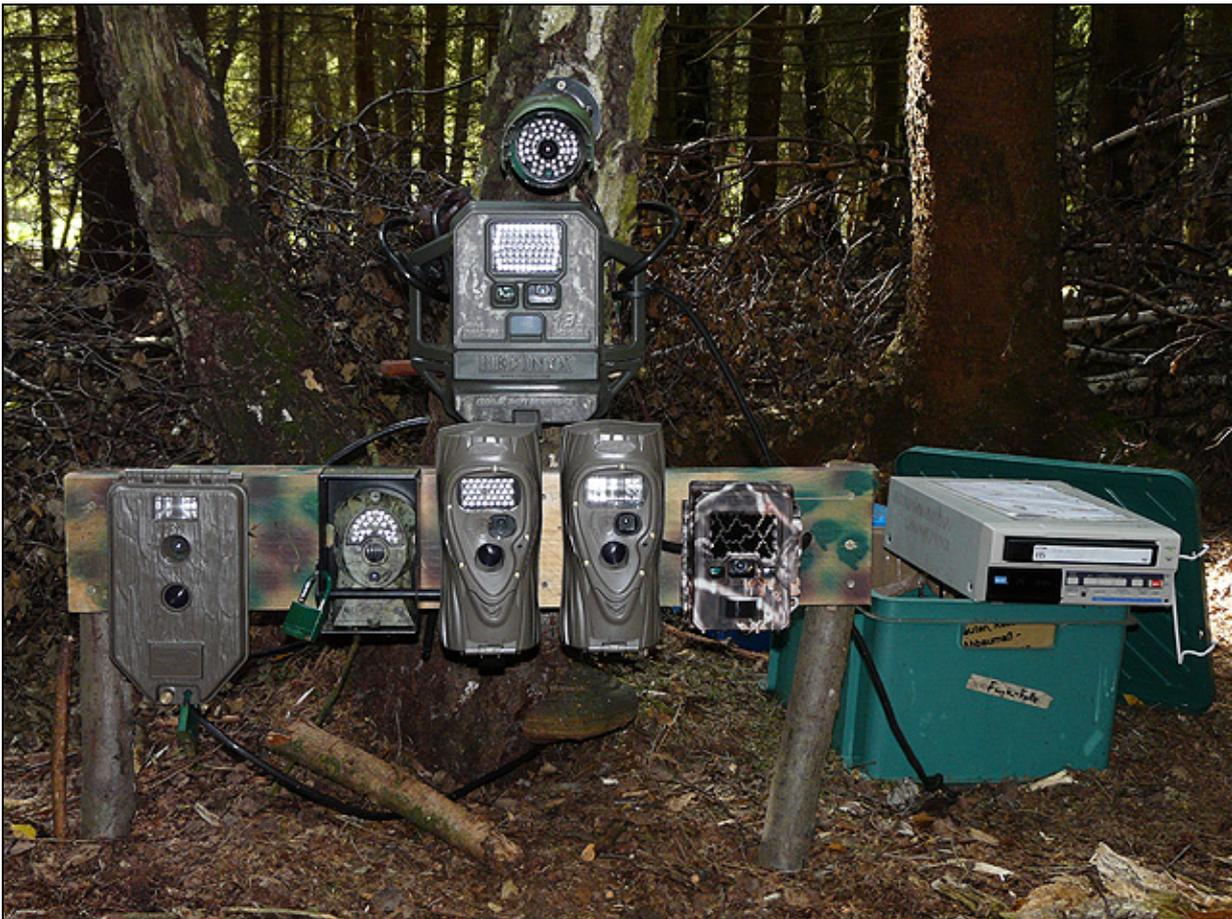
Abb. 7: Versuchsanordnung für den simultanen Test verschiedener Fotofallenmodelle. oben: Kamera einer kontinuierlich aufzeichnenden Videoanlage (rechts im Bild), darunter Reconyx RM45; untere Reihe v.l.: Cuddeback Capture, Dörr BolyGuard, Cuddeback Attack IR, Cuddeback Attack, Reconyx HC600 (Foto: © M. Borchert).
