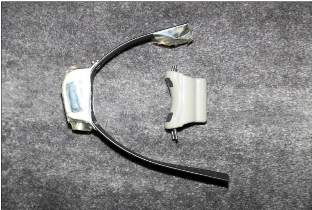
Abb. 7: GPS-Halsbandsender für die Luchstelemetrie (Foto: N. Stier)
