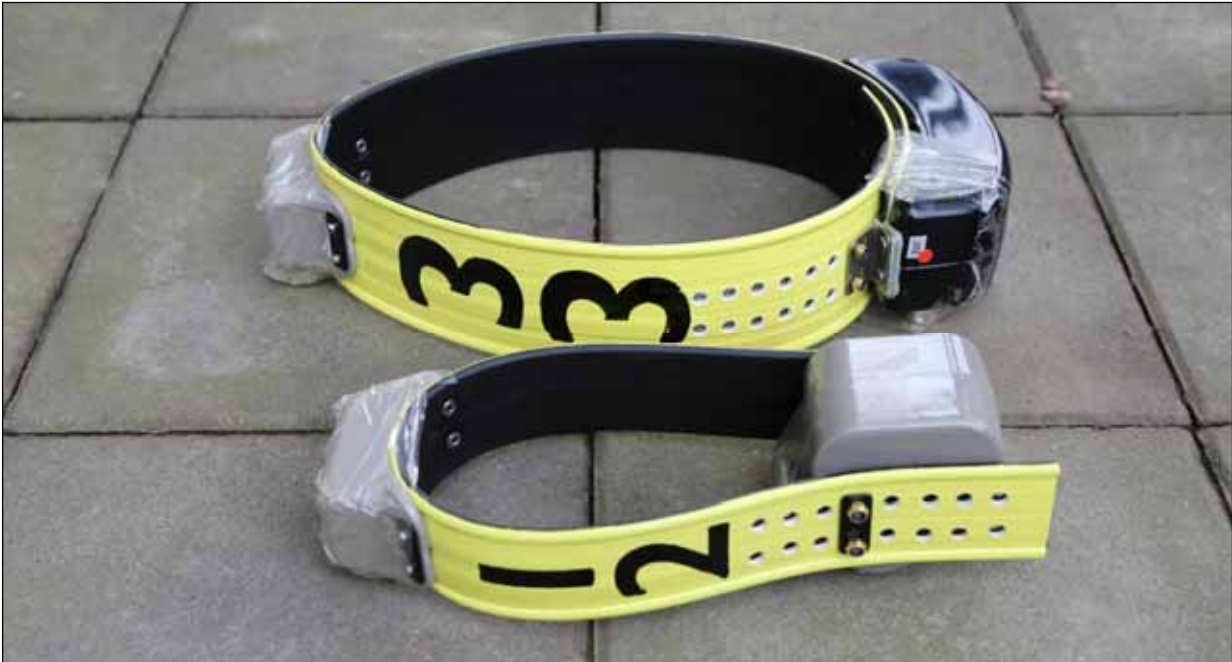
Abb. 66: GPS-GSM-Halsbandsender für männliches (hinten) und weibliches (vorn) Rotwild, Fa. Vectronic (Foto: © N. Stier).
