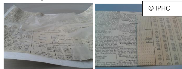
Abbildung 2: Reichsanzeiger nach der Behandlung mit unterschiedlich modifizierter Nanocellulose
