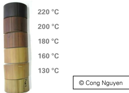
Abb.6: Änderung der Farbe des Dendrocalamus barbatus durch thermische Modifikation unter Stickstoff
