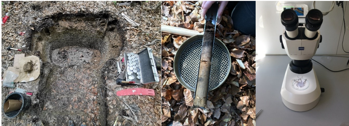
Abbildung 1: Workflow Feinwurzeln – Entnahme der Bodenproben in der Bodengrube, Aufarbeitung der Feinwurzelprobe im Labor.
