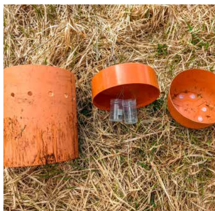
Abb. 2a: Bestandteile der modifizierten Falle nach Nordlander [16], v. l. n. r.: Grundkörper aus KG-Rohr (DN 200), KG-Kappe als Deckel mit Lockstoffbehältern, abgeschnittener Pflanztopf, mit Silikon abgedichtet, als Fangbehälter
