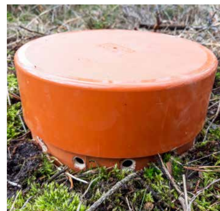
Abb. 2b: Aktive Nordlander-Falle; zu beachten ist, dass die Lochreihe bündig zum Erdboden ausgerichtet wird und sich in Fallennähe keine Veränderungen im Mikrorelief ergeben.
