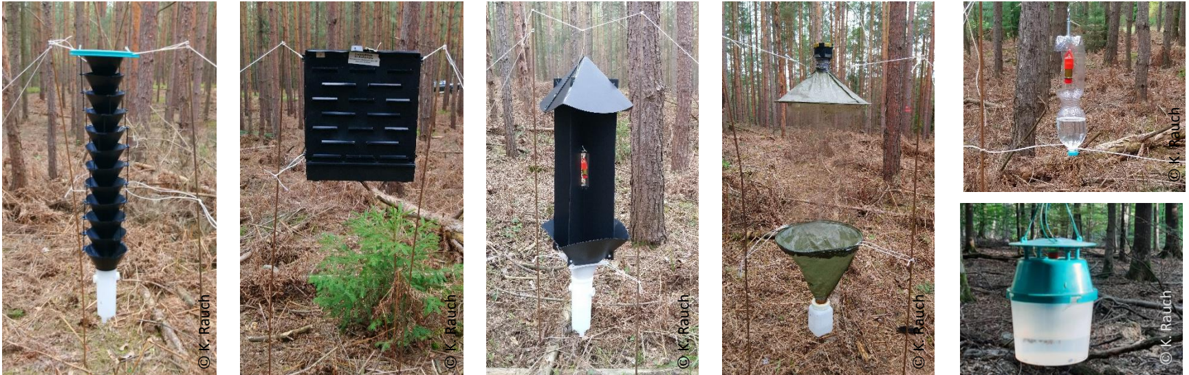
Fallentypen von links: Segmenttrichterfalle, Borkenkäferschlitzfalle, Kreuzbarrieren-/Prallfalle, Fensterfalle, Bottle Trap, Vario Trap
