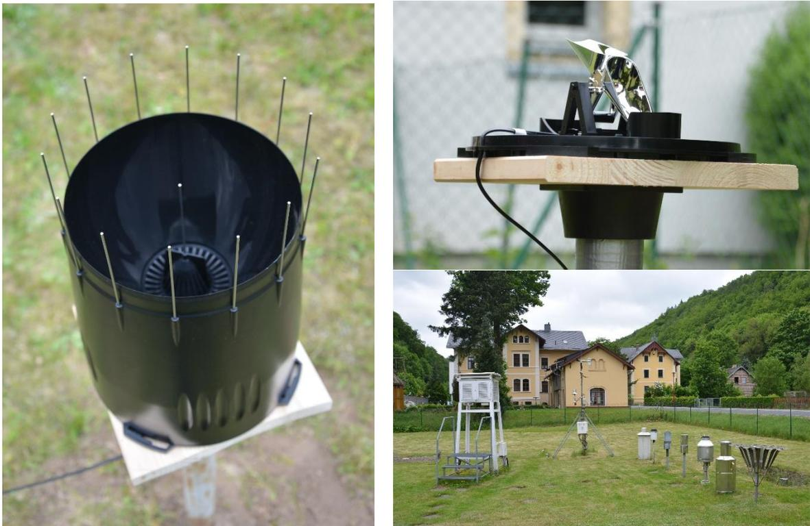
Abbildung 7: Low-cost Kippwaage zur Messung von Niederschlagsmengen: Messkegel (links), Kippwaage (rechts oben); Regensensoren zur Kalibrierung im Messfeld (rechts unten).
