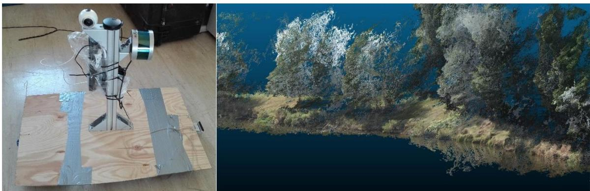
Abbildung 9: Uferaufnahme mit einem UWW: Prototyp mit Laserscanner und 360°-Kamera (links); mit SfM generierte 3D-Punktwolke des Ufers (rechts)
