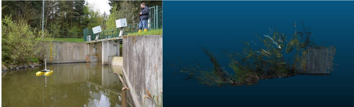
Abbildung 10: Uferaufnahme mit dem UWW: Ferngesteuertes Messboot am Heidemühlenteich (links); mit SfM generierte 3D-Punktwolke des Ufers (rechts)
