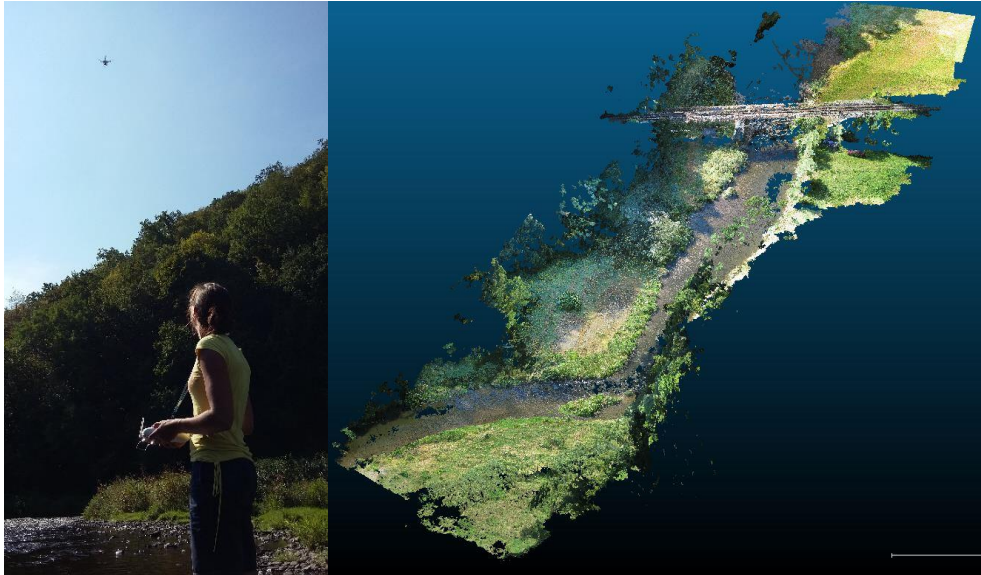
Abbildung 8: Geländeaufnahme mit einem UAV: Befliegung an der Freiburger Mulde (links); mit SfM generierte 3D-Punktwolke (rechts).
