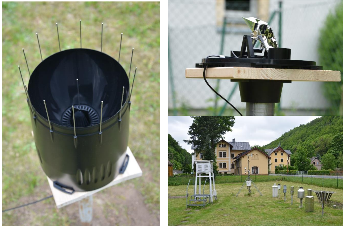
Abbildung 7: Low-cost Kippwaage zur Messung von Niederschlagsmengen: Messkegel (links), Kippwaage (rechts oben); Regensensoren zur Kalibrierung im Messfeld (rechts unten).
