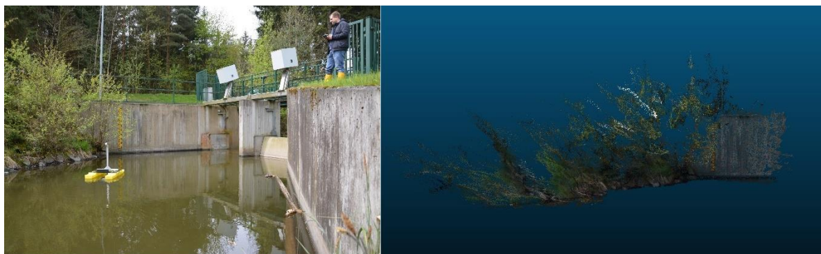
Abbildung 16: Uferaufnahme mit dem UUV: Ferngesteuertes Messboot am Heidemühlenteich (links); mit SfM generierte 3D-Punktwolke des Ufers (rechts)
