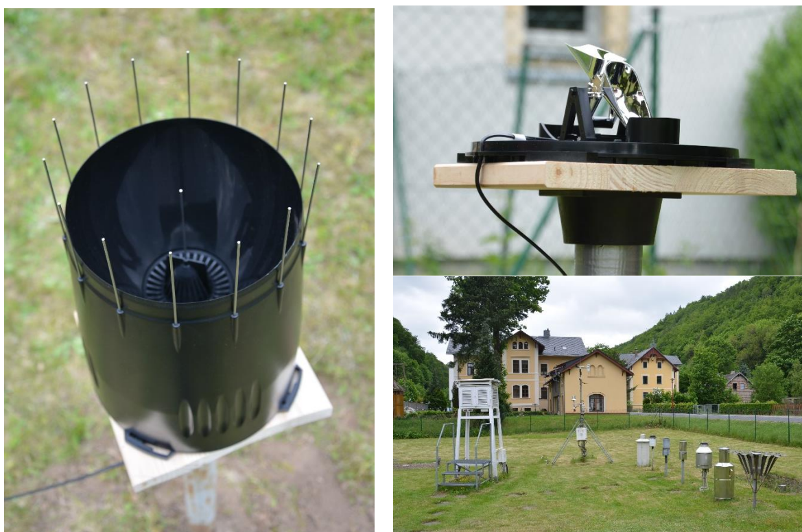
Abbildung 12: Low-cost Kippwaage (Davis) zur Messung von Niederschlagsmengen: Messkegel (links), Kippwaage (rechts oben); Regensensoren zur Kalibrierung im Messfeld (rechts unten).
