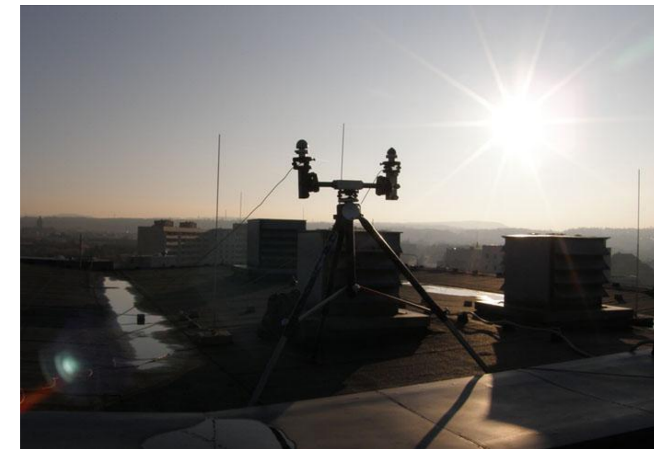
Abb. 4: 1,6 Meter hoher Aufbau zweier low-cost-Antennen auf dem Dach des Studentenwohnheimes
