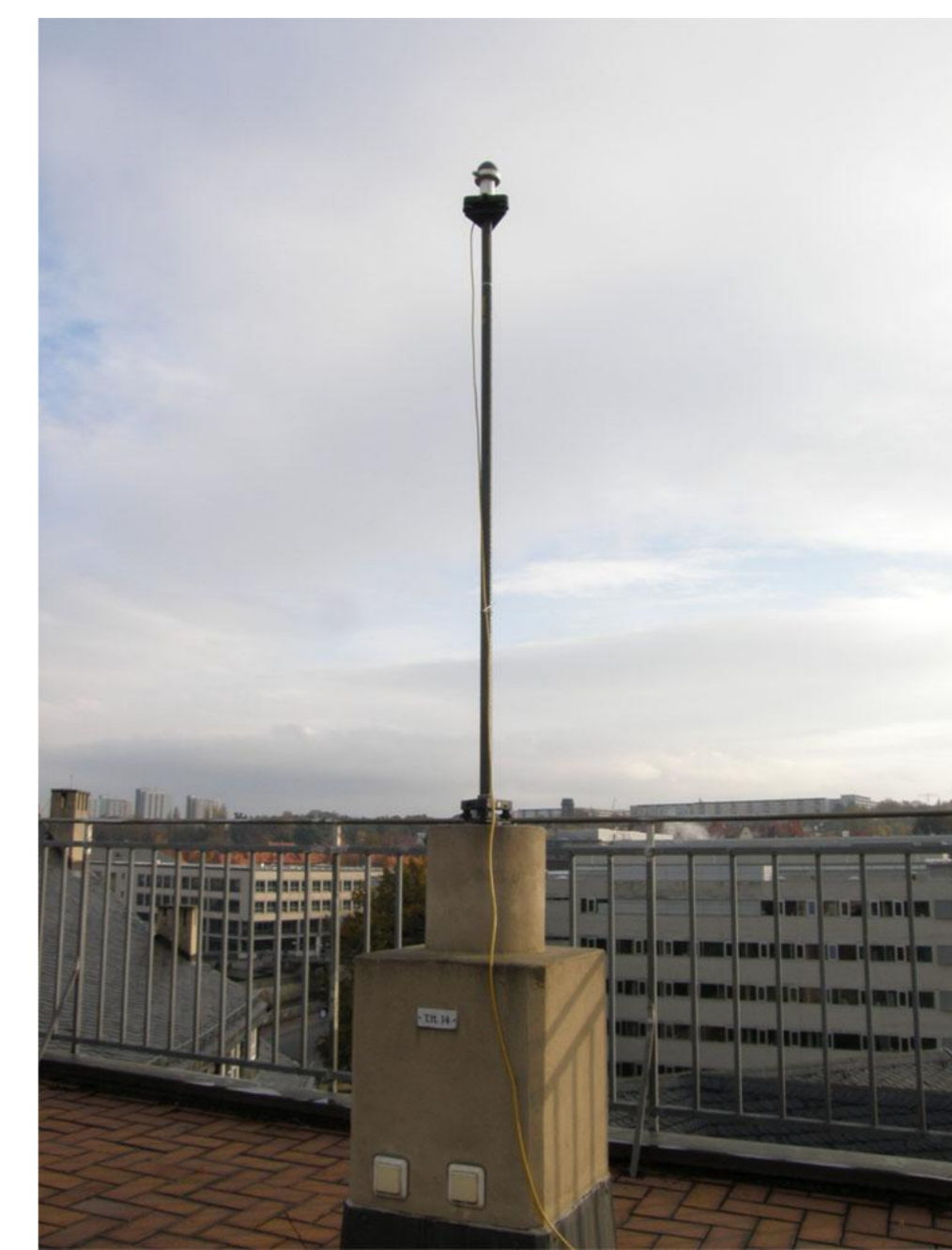
Abb. 1: Zwei Meter hoher Aufbau einer low-cost-Antenne auf einem Pfeiler des Beyer-Baus
