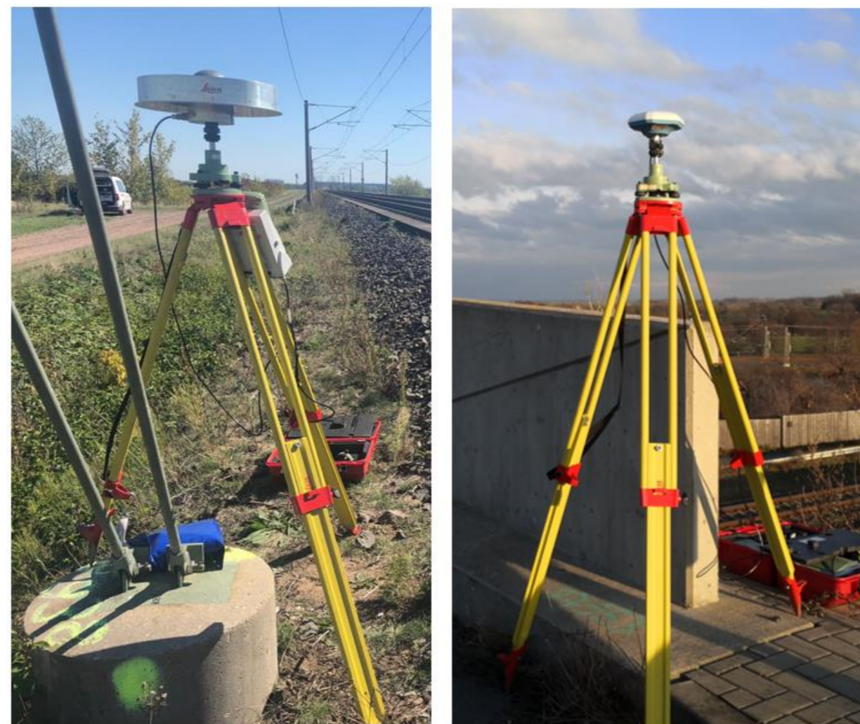
Abb. 2: Vergleich der Antennen (links: Leica AT504 GG mit Chokeringen, rechts navXperience 3G+C)
