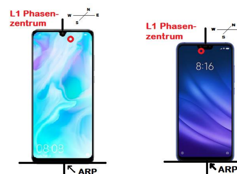
Abb. 4: L1-Antennenphasenzentrum des Huawei P30 (links) und des Xiaomi Mi 8 (rechts)
