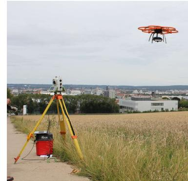
Abb. 1: Verwendete Instrumente, links: Leica Nova MS60 rechts: IndustrieUAV Aibot X6 mit dem Aibot HP GNSS 2 Modul
