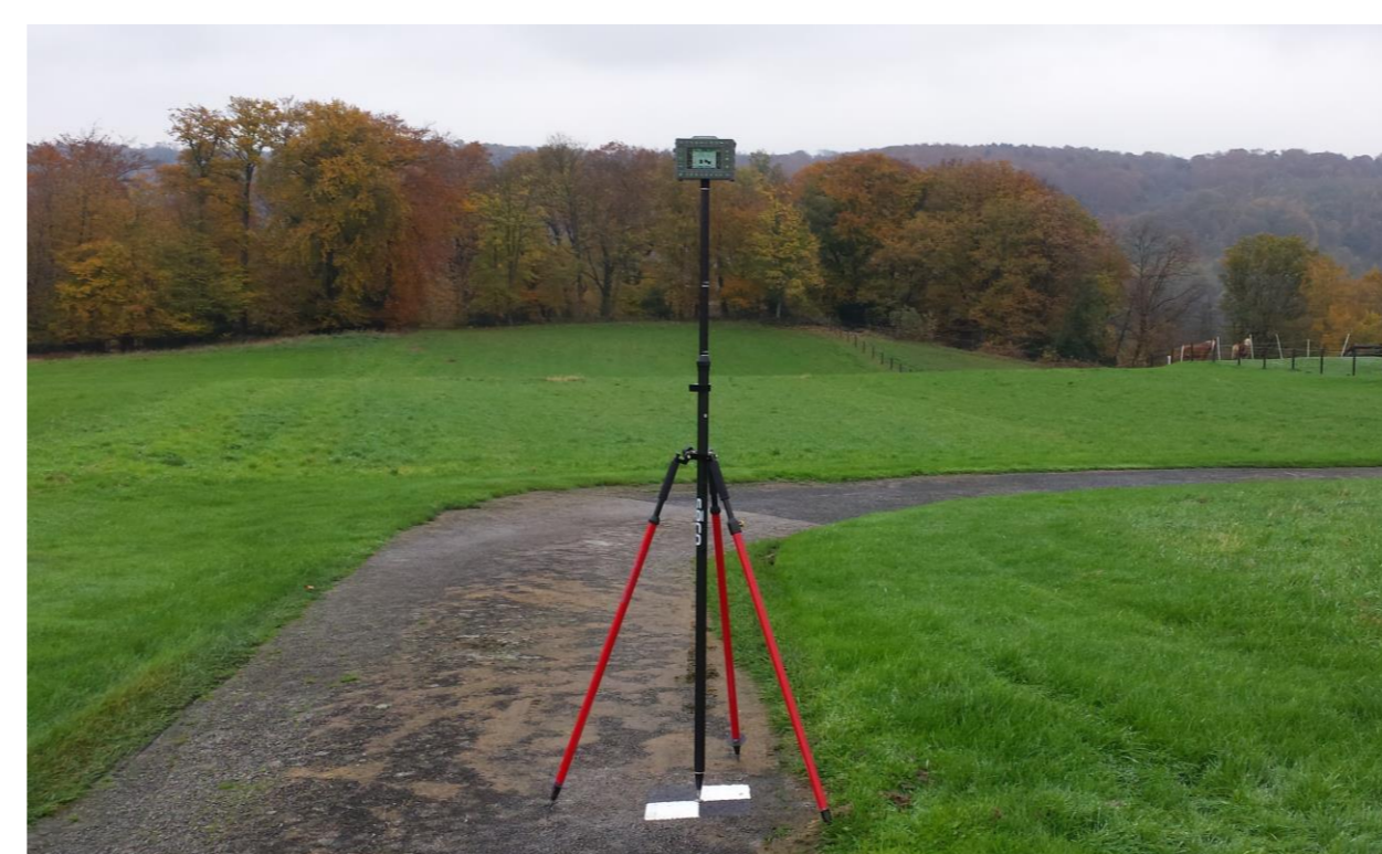
Abb. 1: Messaufbau für Passpunktmessung
