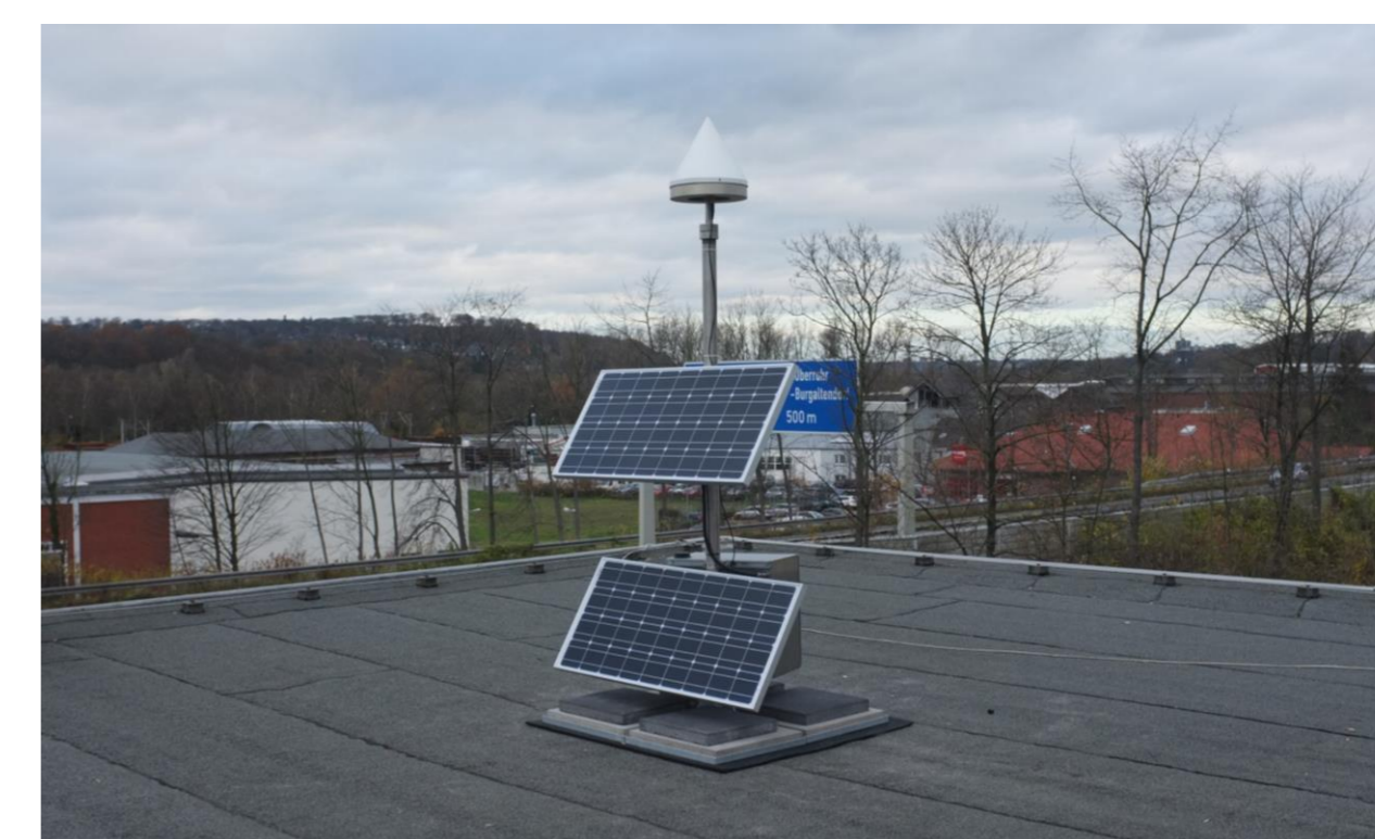
Abb. 2: Aufbau einer lokalen Referenzstation
