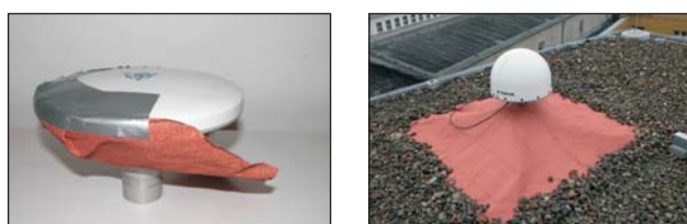
Abb. 3: a) Rover Antenne mit auf der Antennen-Unterseite angebrachtem Abschirmgewebe b) Möglicher Einsatz des Gewebes auf einer Referenzstation zum Verdecken der großen Reflektionsfläche unterhalb der Antenne
