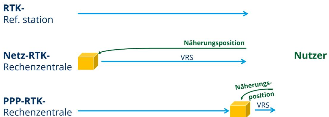
Lambert Wanninger, TU Dresden: Präzise GNSS-Positionsbestimmung: RTK, Netz-RTK, PPP-RTK
