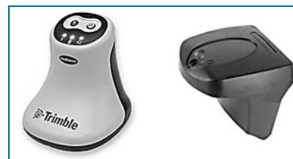
Abb. 2: Die verwendeten Beacon-Empfänger der Firmen Trimble und Thales
