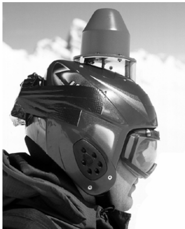
Abb. 1: Skihelm mit aufgesetzter Zweifrequenzantenne. Im hinteren Teil ist der Antennenvorverstärker zu erkennen.
