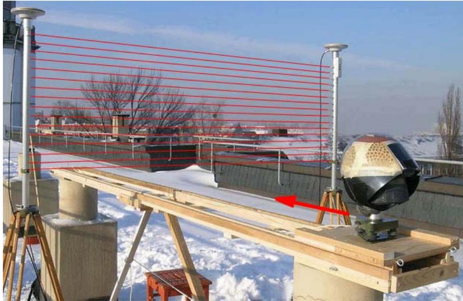
**Abb. 4-16:** Kalibrierung des Laser-Lichtschrankensystems LLBA16 und des GPS-Helms auf der Messplattform des Geodätischen Instituts der TU Dresden. Der Helm ist hier noch mit einer transparenten Schale versehen, damit die Lage der integrierten GPS-Antenne (im Helm oben) optisch bestimmt werden kann. Unter der Antenne befindet sich der Datenlogger, im Hinterkopfbereich der GPS-Empfänger.
