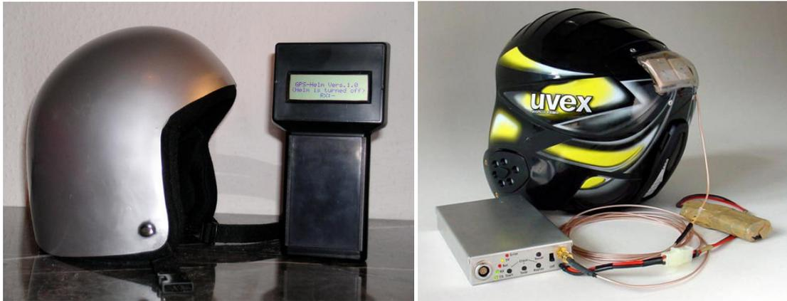
**Abb. 4-1:** links: GPS-Helm Version II mit externem Display zur Anzeige aktueller Systemparameter. rechts: GPS-Helm Version I. Nur die Antenne befindet sich im Helm. Der Empfänger mit Batterie wurde in einer Gürteltasche getragen.
