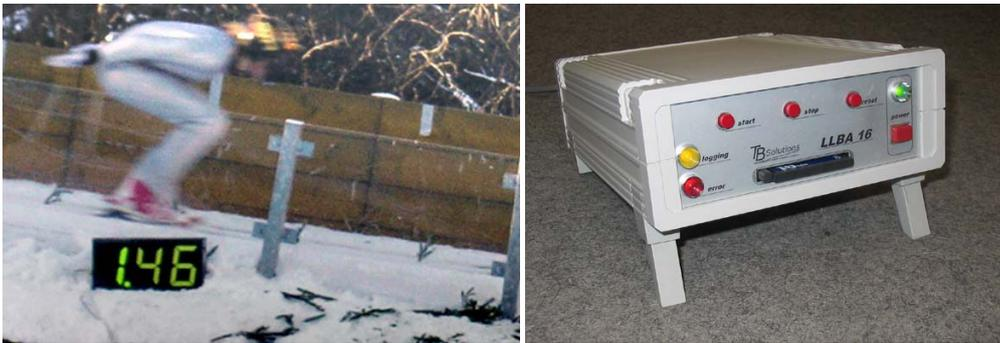
Abb. 4-13: links: Eine Anzeige stellt als Sofortinformation für den Trainer die Höhe des Helms über dem Tisch dar. rechts: Steuergerät für das Laser-Lichtschrankensystem LLBA16. Wie beim GPS-Helm werden auch hier die Daten auf einer CompactFlash-Karte gespeichert.
