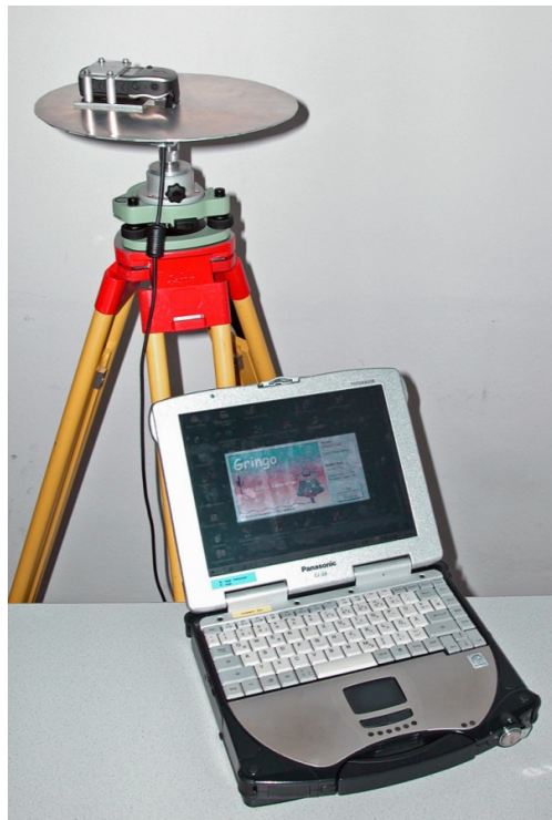
Abbildung 2: Garmin eTrex Vista mit Adapter, Abschirmung und robustem Notebook
