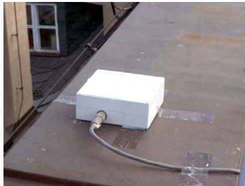
Abbildung 11: H-Feld-Antenne befestigt auf dem Dach des Bayerbaus, TU Dresden (BEY)
