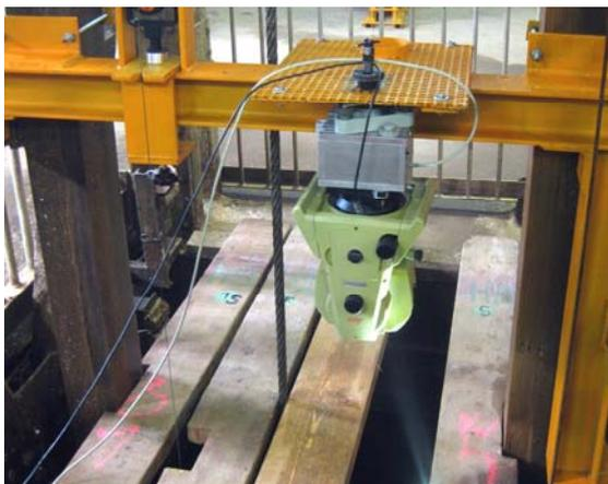
Abb. 3: Hängetachymeter im Schacht
