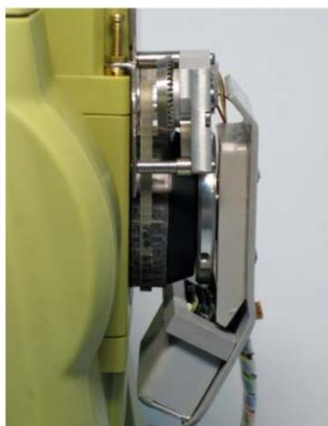
Abb. 2: Kamera und Fokussierantrieb
