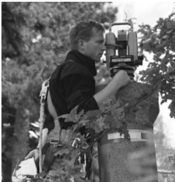
Bild 5. Theodolit auf einem Beobachtungspfeiler
