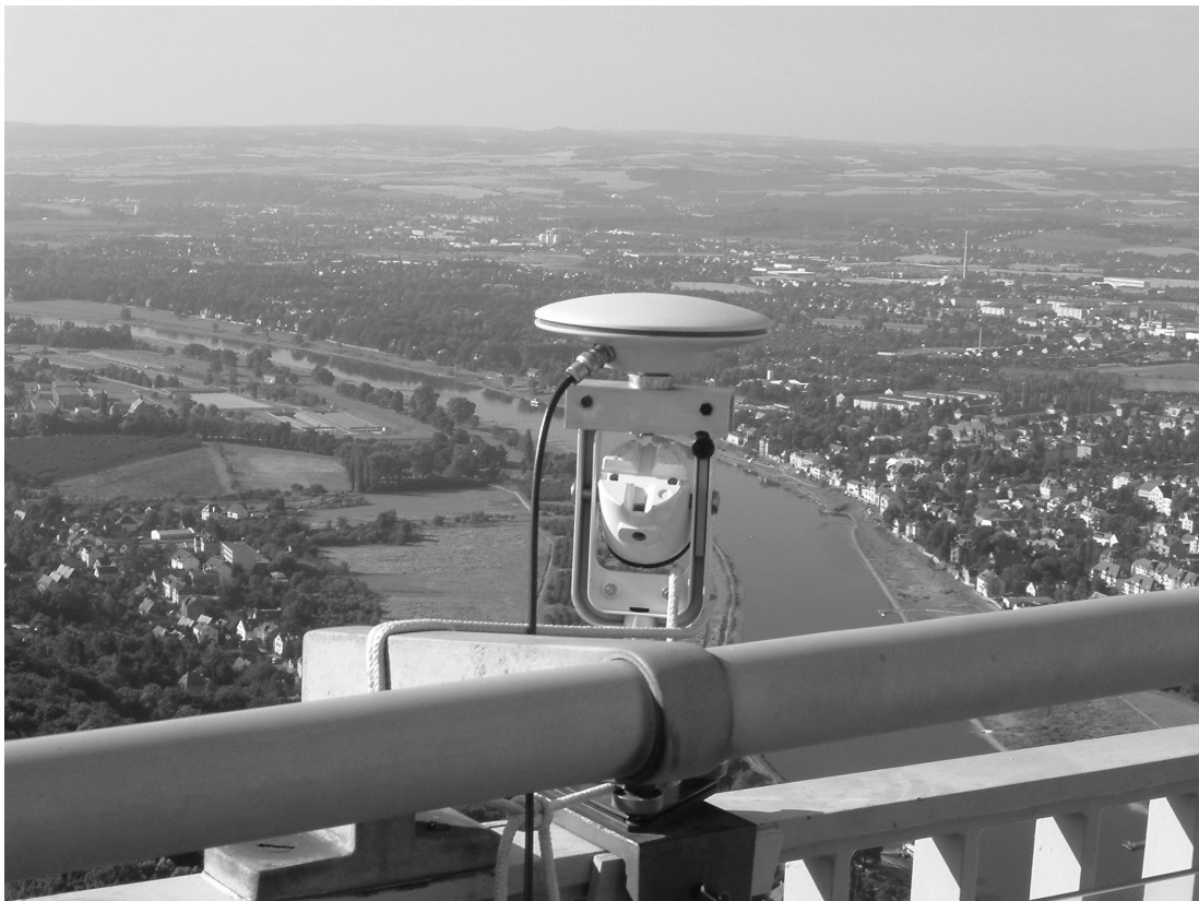
Abb. 2: Reflektor mit GPS-Antenne
