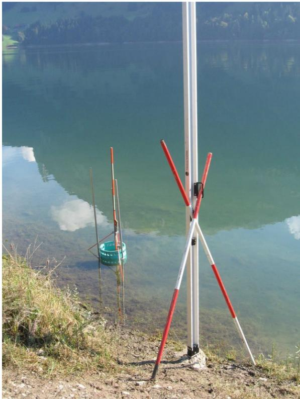
Um Einflüsse von kurzperiodischen Wasserspiegelschwankungen (Wellen) weitestgehend zu eliminieren, wird die Fluchtstange durch einen entsprechenden Behälter in Form eines beidseitig offenen Zylinders geschützt (Abb. 4).
