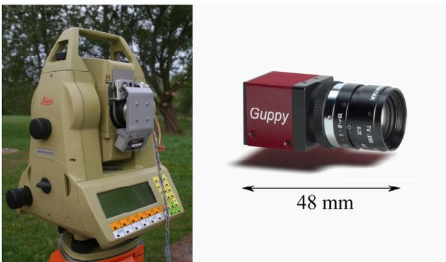
**Abb. 2:** (links) Leica TCA 2003 mit aufgesetzter Okularkamera und montiertem Schrittmotor, (rechts) Basiskamera AVT Guppy F-080B (*/AVT 2009/*)
