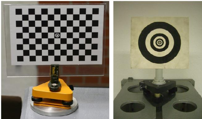
Abb. 4: (links) Zielzeichen mit Schachbrettmuster, (rechts) flächiges Zielzeichen bestehende aus konzentrischen Ringen
