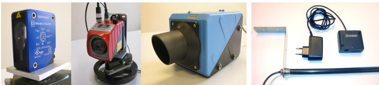
**Abb. 2: Systemkomponenten (v.l.n.r.): Datalogic S80, Leuze AMS 200, Sick DMT 10-2-111, Cinterion MC52**
