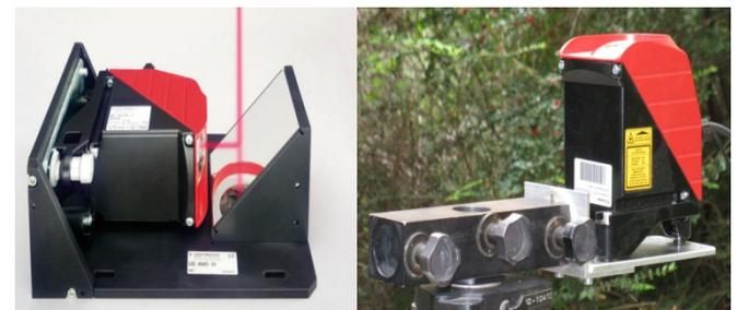
Abb. 4: Spiegelsystem zur Umlenkung des Laserstrahls (links), Vorrichtung zur Messung in Zenitrichtung (rechts)
