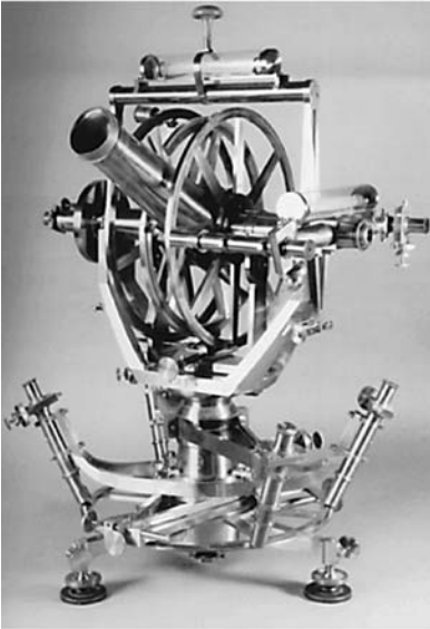
Abb. 6 Universalinstrument von A. u. G. Repsold, Hamburg (1863). Von Prof. Nagel zur Winkelmessung in der Europ. Gradmessung benutzt (Briefkarte TUD)
