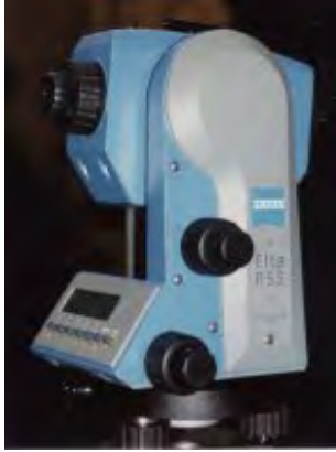
Abbildung 2-18: Elektronisches Bautachymeter Elta R55 der Firma Zeiss (url: [ http://www.gi.geo.tu-dresden.de/ ], 2005)
