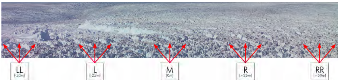
Abbildung 6-6: Messkonfiguration für die Stereobildaufnahmen
