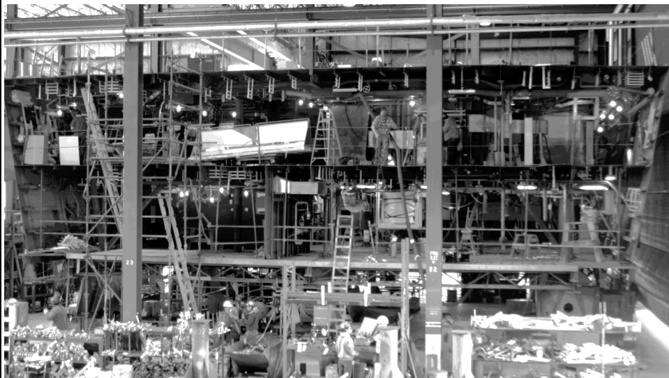
Abb. 1.: Rumpf auf Baudock, Sektion in Montagehalle
