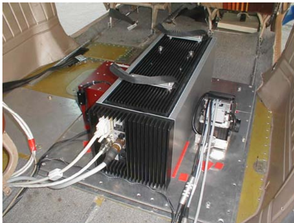
Abb.1 Aufbau mit Laserscanner, IMU-Einheit und Kamera (Abb. Kamera Rollei-Prospekt)
