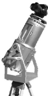
Abb. 1: Scanner Riegls LMS-Z420i mit aufgesetzter NIKON D100
