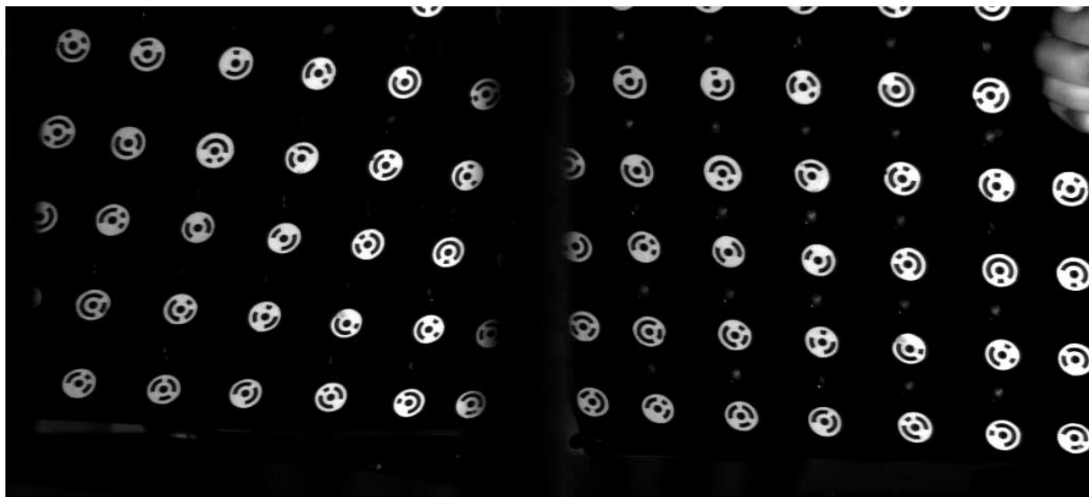
Abb. 3: Aufnahme der Kamera (Bildformat 1024 x 512) über ein Stereoprismensystem.
