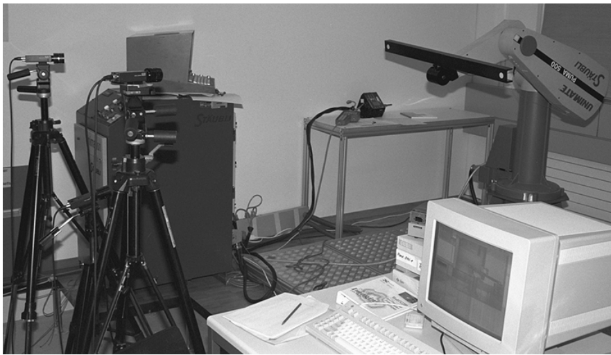
Abb. 5: Bewegter Referenzstab in einer Pilotstudie zur Roboterkalibrierung (Maas, 1996)
